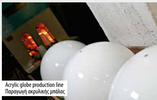
Injection machine producing globe pre-form Μηχανή injection παράγει pre-form μπάλας
